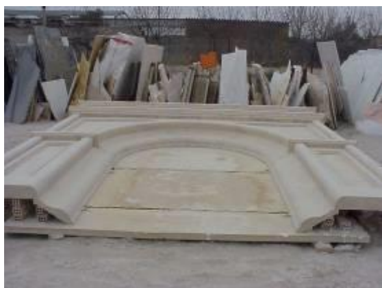
Tagozatos bejárati kőkeret összeállítása üzemben
